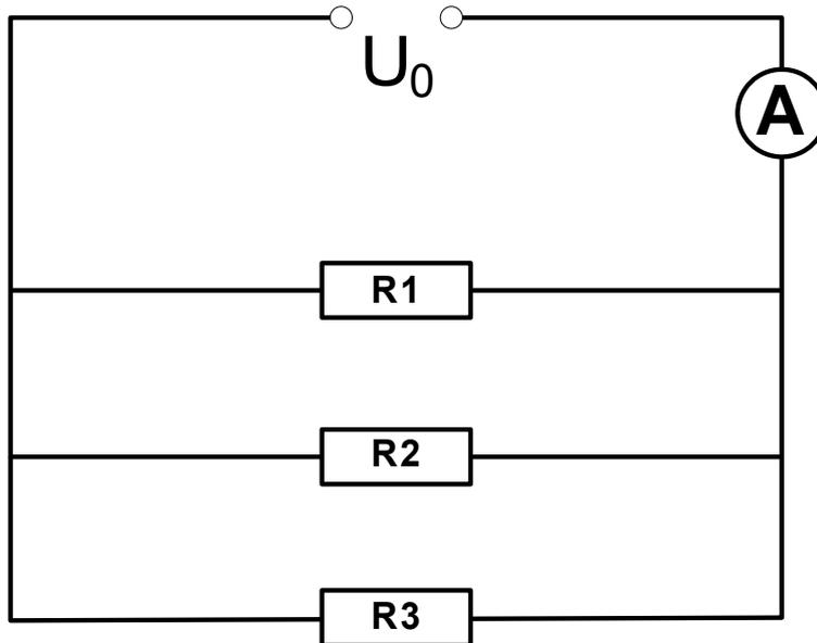
$U_0 = 20\text{ V}$ ,  $I_0 = 0,4\text{ A}$ ,  $R_1 = 300\ \Omega$ ,  $R_2$  ist doppelt so groß wie  $R_3$
