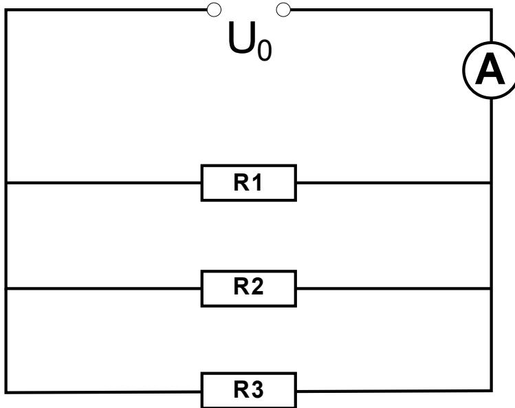
$U_0 = 40 \text{ V}$ ,  $I_0 = 0,2 \text{ A}$ ,  $R_3 = 400 \Omega$ ,  $R_1$  ist doppelt so groß wie  $R_2$ ,
